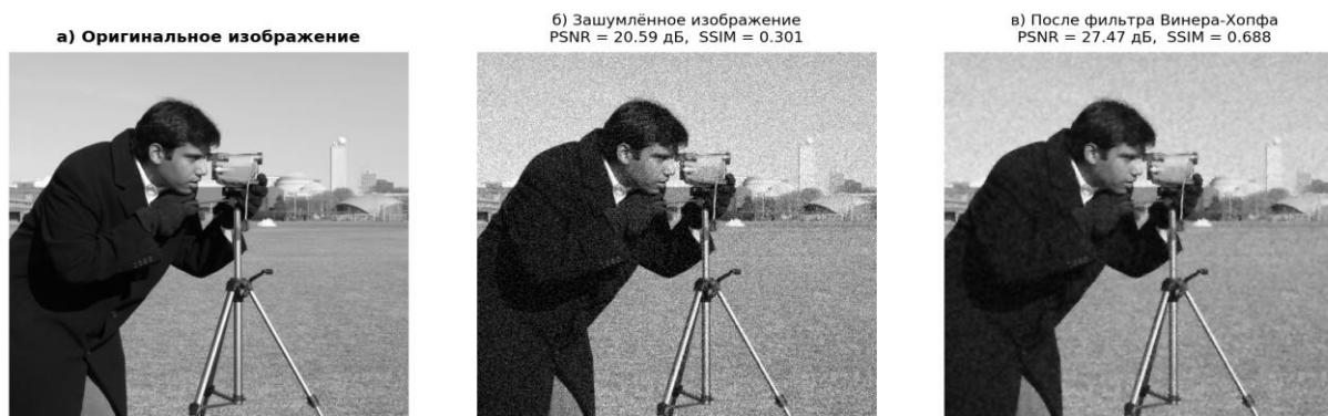
Рис. 1. Сравнение изображений: а) оригинальное (Cameraman, 512×512), б) зашумлённое ( \sigma = 25 , PSNR = 20,59 дБ, SSIM = 0,301), в) после фильтра Винера-Хопфа (PSNR = 27,47 дБ, SSIM = 0,688)
